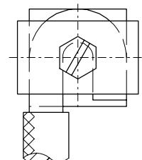
У моторов с клеммными коробками, которые между крышкой и нижней частью имеют шлифованные поверхности следует для изоляции и защиты от коррозии предусмотреть тонкий слой смазки.
