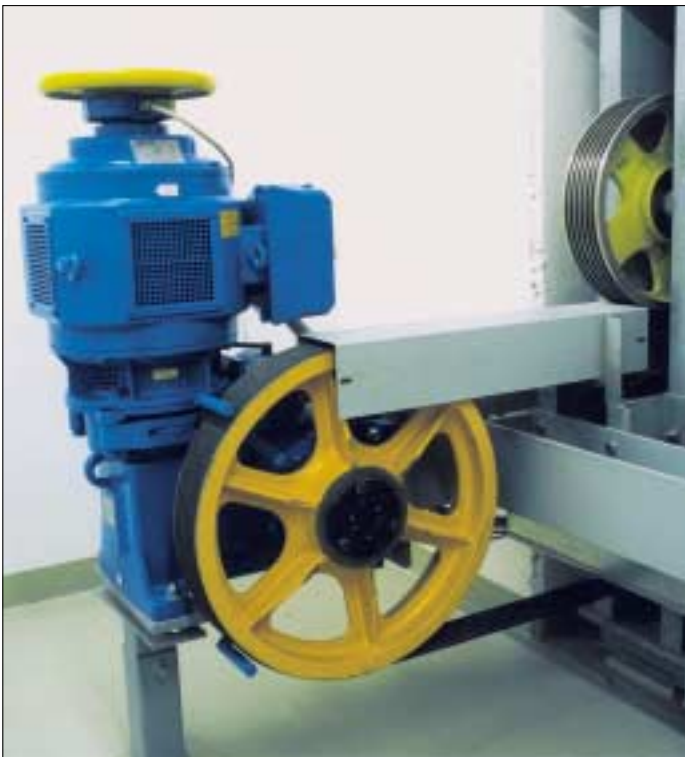
Flender-Aufzugsantrieb für Nutzlast Q = 825 kg und Fahr- geschwindigkeit 1 m/s. Seilabhängung 2:1 Loher-Aufzugsmotor LUGA-132LN-04, 7,5 kW RUPEX-Kupplung Bauart RWB-125 Doppelbackenbremse für T_{\text{Brems}} = 2 \times 80 Nm Schnecken-Stirnradgetriebe CG26-100, i = 18,75 Treibscheibe \varnothing 450
