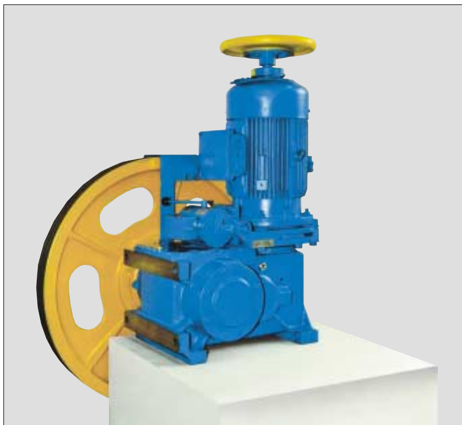
Abb. 3: Flender-Aufzugsantrieb für Nutzlast Q = 1500 kg und Fahrgeschwindigkeit 1,2 m/s. Seilabhängung 2:1 und Gegengewichtsausgleich 50 %
